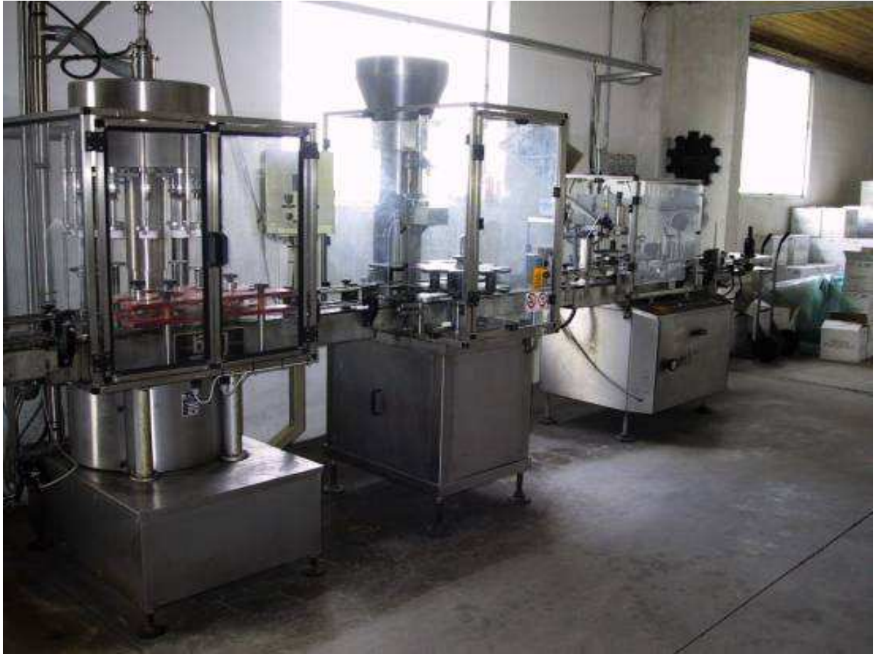
Aftapningsanlæg efterfulgt af prop-, folie- og etikettemaskine hos mindre producent.
