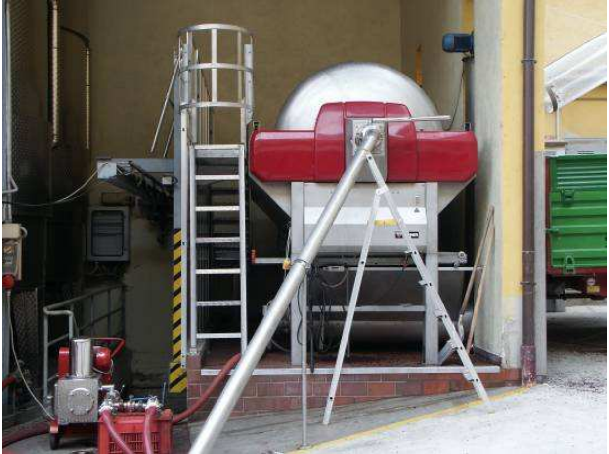
Den sidste del af vinen med skaller og kerner køres igennem en pneumatisk presse.
