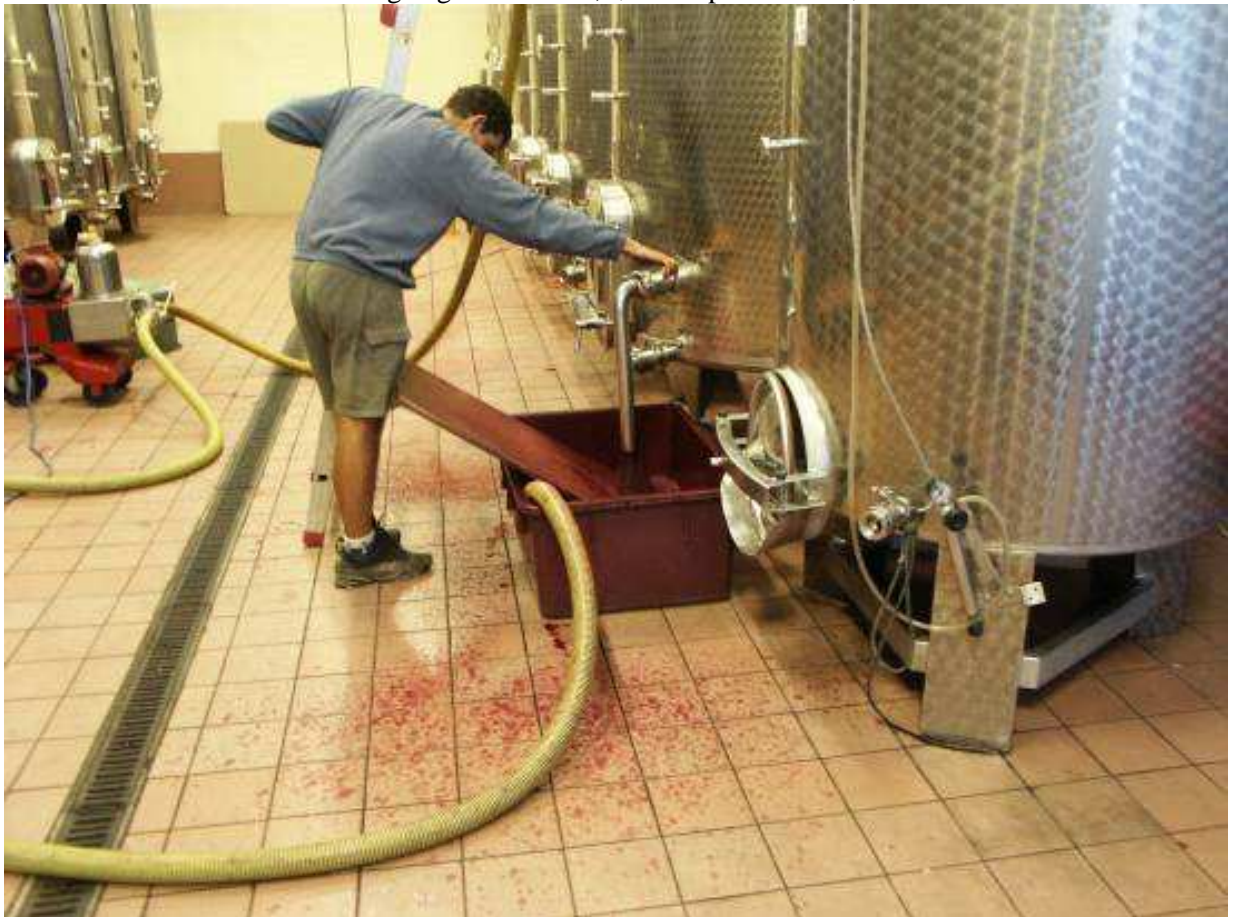
Drumosten tappes af tanken for derefter at blive pumpet op ovenpå "hatten" af skaller og kerner.
