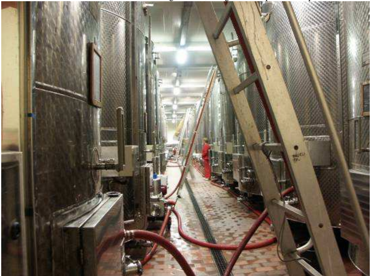
Et helt batteri af store rustfrie gærings- og lagertanke hos større producent.
