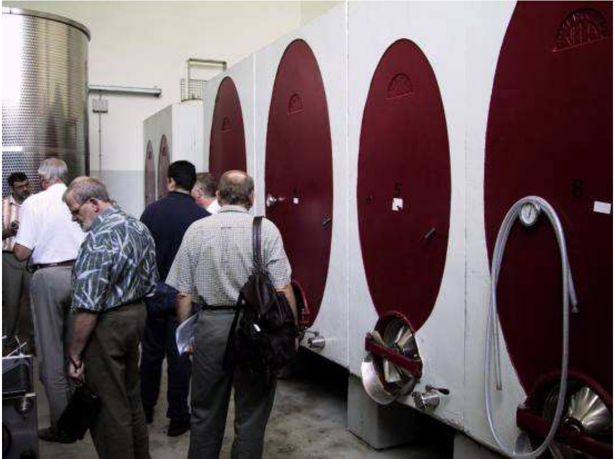
Betontanke som er malet indvendigt med epoxy.
