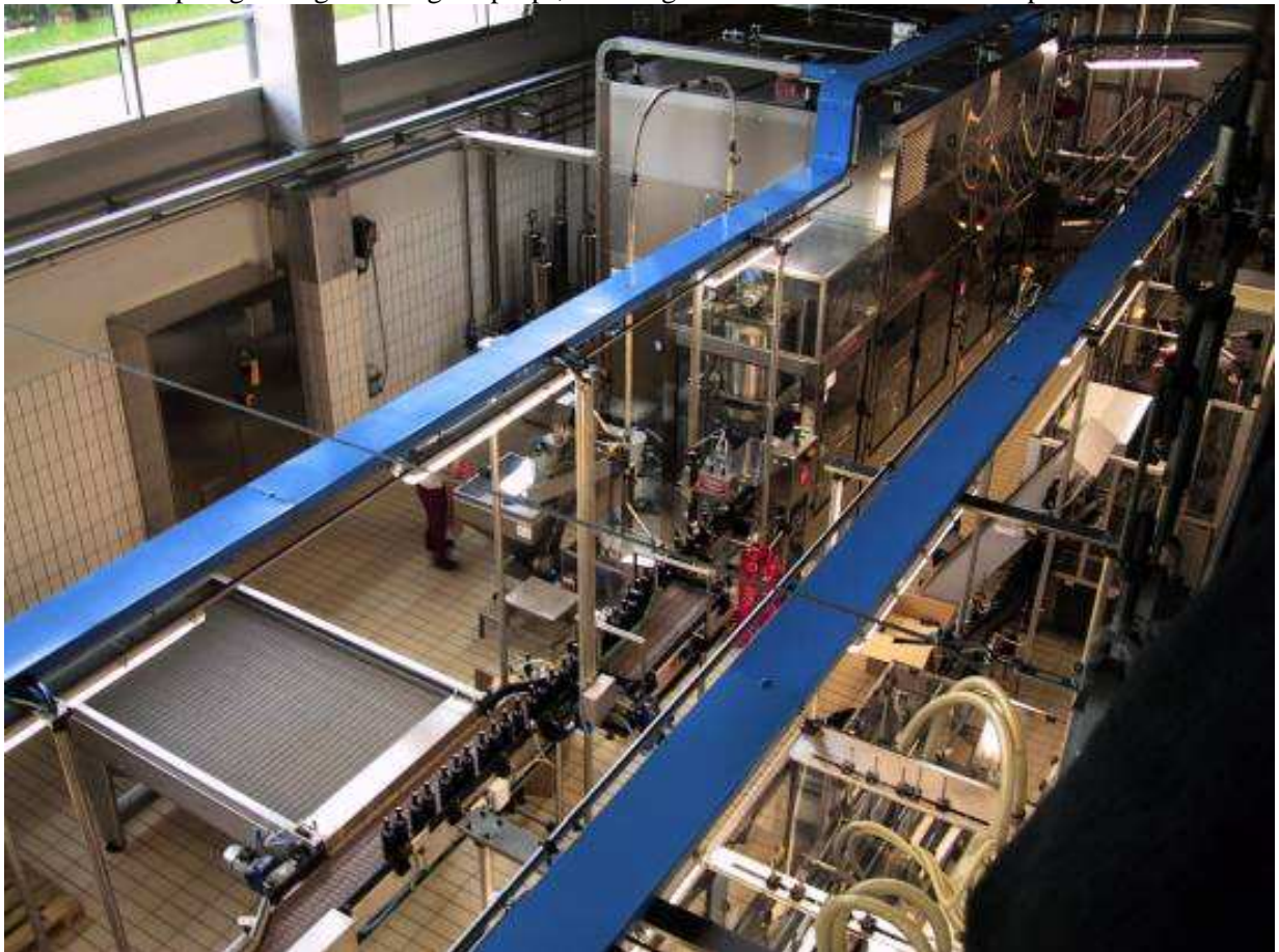
Aftapningsanlæg efterfulgt af prop-, folie- og etikettemaskine hos større producent/kooperativ.
